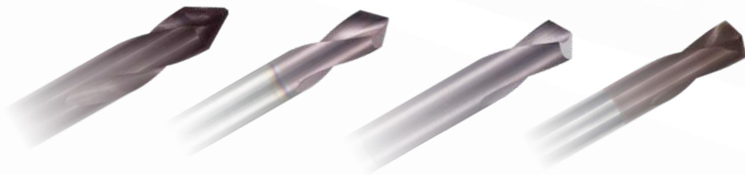
NC機械による正確な位置決めのためのセンタ穴加工には、剛性が高くしかも高精度で高品質な工具が必要となります。ゲーリングのNC-スポットティングドリルは、ハイス・コバルトハイス・超硬等の素材で各種コーティングのレギュラ及びロングシリーズを取り揃えております。また、加工被削材や加工用途に応じて60°/90°/120°/145°の角度が選定可能です。
